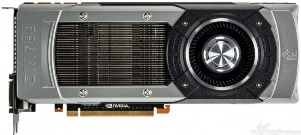
La ventola è di tipo radiale ed è incastonata all'interno della struttura del dissipatore; l'aria calda viene convogliata sino al bracket VGA ed espulsa direttamente all'esterno, evitando così di creare ristagni di calore all'interno del nostro case.
