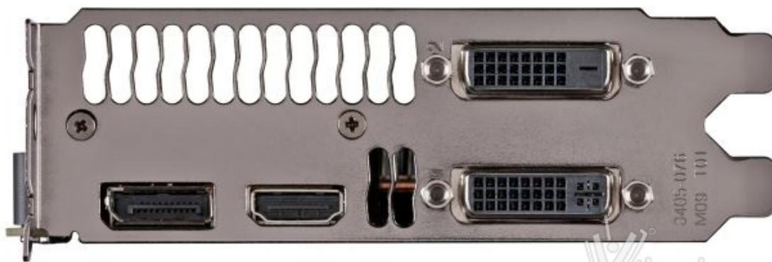
La GeForce GTX 780 supporta l'utilizzo di quattro schermi contemporaneamente, abbinando le due uscite DVI-DL, con le connessioni DisplayPort e HDMI.
