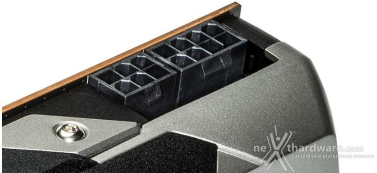
Il Thermal Design Power (TDP) dichiarato da NVIDIA per la GeForce GTX 780 è pari a 250 Watt, aspetto che ha reso necessario l'installazione di un connettore ausiliario PCI-E 8 pin (150 Watt) e di uno da 6 pin (75 Watt), che vanno ad affiancarsi ai 75 Watt erogati dallo slot PCI-E 16x.
