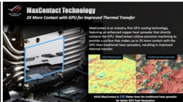
Ma non è finita qui, perché la ROG Strix GTX 1080 OC Edition sarà raffreddata da un dissipatore che avrà solo la parvenza del DirectCU III montato sulle sorelle minori Strix GTX 1080 e Strix GTX 1070, in quanto ASUS sembra aver incrementato di un 40% la superficie di scambio termico utilizzando, tra l'altro, una nuova tecnologia, denominata MaxContact, che comporta una base di contatto con la GPU sino a 10 volte più liscia e omogenea del normale offrendo, quindi, una maggiore conduttività .
