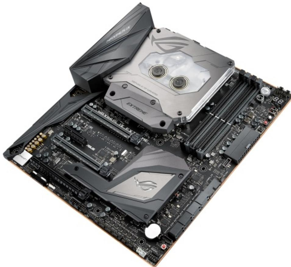
Fra le altre chicche segnaliamo i nuovi slot per memorie dotati di tecnologia SafeDIMM,↔ in grado di garantire una maggiore durata nel tempo grazie alla presenza di un rinforzo in metallo, un connettore ATX ruotato di novanta gradi e dotato di tecnologia ProCool per migliorare il contatto, i jack audio dotati di LED che ne facilitano l'individuazione e, infine, il supporto nativo alla tecnologia Thunderbolt 3.0 tramite il connettore USB 3.1 Type C presente nel backpanel.
