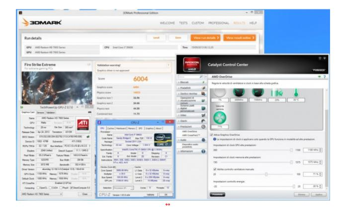
La nostra AMD Radeon HD 7990 ha raggiunto con facilità le massime frequenze impostabili dal Catalyst Control Center (**1100MHz** per la GPU e **1575MHz** per le memorie), a patto però di innalzare la velocità delle ventole al 71% della velocità massima consentita, ottenendo una rumorosità pari a **68 dBA**, un valore decisamente elevato e difficilmente tollerabile sul lungo periodo.
