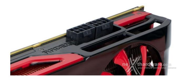
Per la corretta alimentazione della AMD Radeon HD 7990 è necessario collegare due cavi di alimentazione PCI-E 8 pin, in grado di erogare ciascuno 150W, che si vanno a sommare ai 75W disponibili dallo slot PCI-E 3.0.
