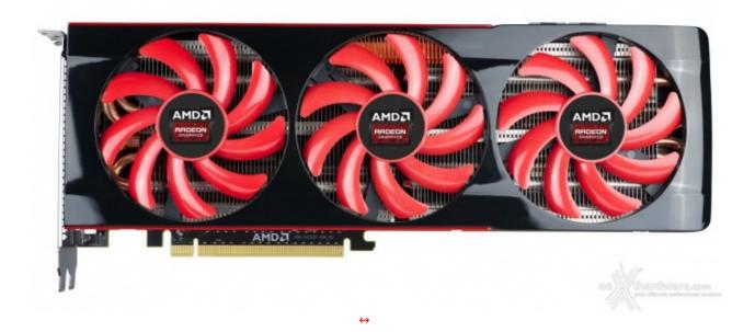
A differenza delle altre HD 7990 lanciate sul mercato fino ad oggi, il nuovo modello di riferimento di AMD ha un ingombro di soli due slot PCI al pari delle altre schede video di fascia alta, caratteristica resa possibile dal complesso sistema di raffreddamento scelto da AMD.
