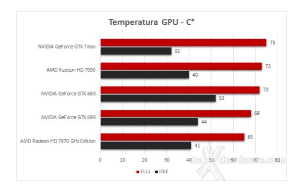
Il nostro consiglio, comunque, è quello di curare attentamente il ricircolo dell'aria all'interno dello chassis del PC: le tre ventole, come già specificato nelle precedenti pagine, non espellono tutta l'aria calda all'esterno, andando così a scaldare indirettamente altri componenti.
