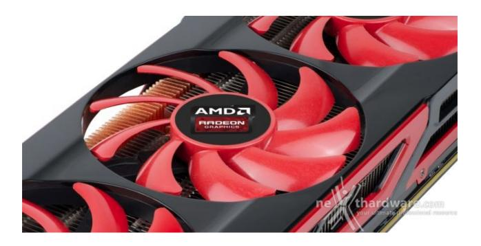
La scheda rappresenta la punta di diamante di AMD ed è equipaggiata con due GPU "Tahiti" dotate di tecnologia AMD PowerTune Technology with Boost e ben 6GB di memoria GDDR5, 3GB per ogni GPU.
