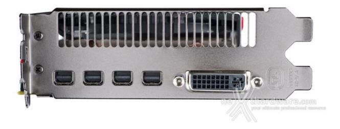
La Radeon HD 7990 supporta uno schermo DVI-Dual Link e quattro schermi DisplayPort, attraverso altrettante connessioni Mini DisplayPort.
