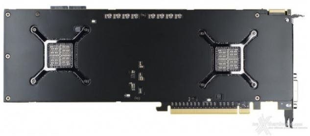
Il retro della scheda è protetto da una placca in metallo che garantisce un elevato grado di protezione al PCB e ai 12 moduli di memoria GDDR5 su di esso saldati.
