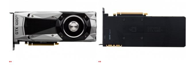
Per quanto concerne la versione Founders Edition, ovviamente l'unica mostrata, abbiamo un sistema di alimentazione a 7 fasi con 14 dualFETs ed un più efficiente dissipatore con una Vapor Chamber di dimensioni maggiorate rispetto a quanto presente su TITAN X, il che dovrebbe tradursi in una maggior incisività della tecnologia GPU Boost 3.0 grazie a temperature di esercizio decisamente più basse.
