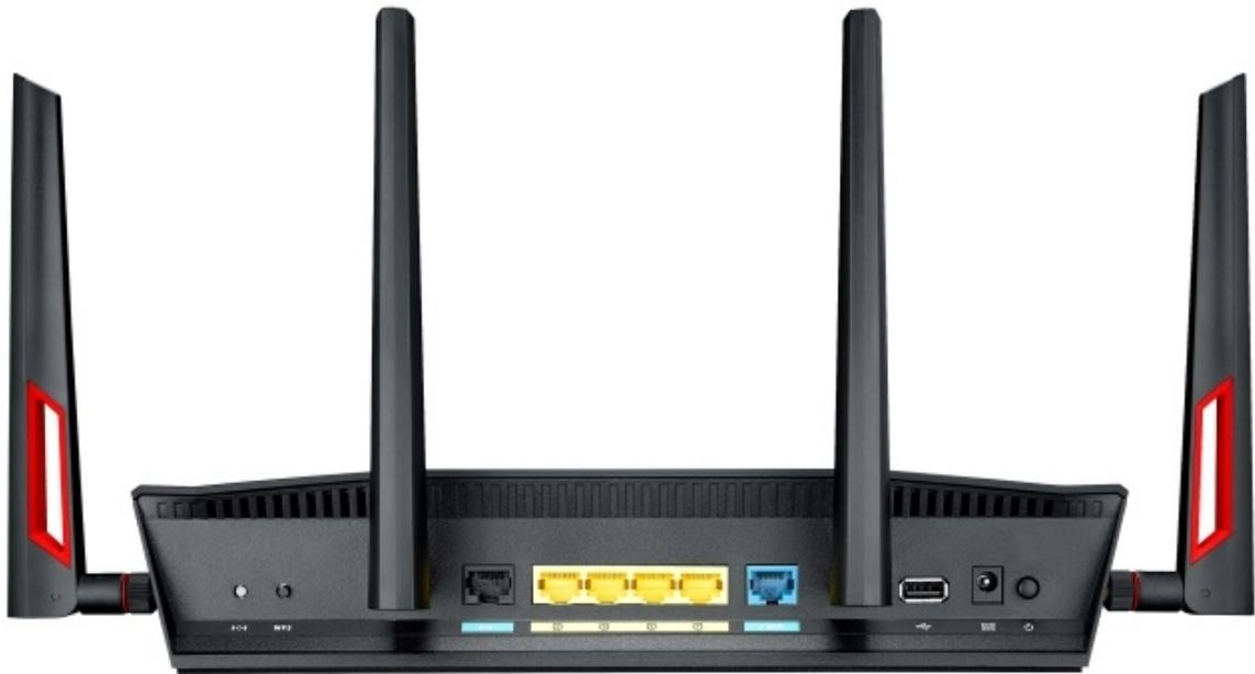
Decisamente completa anche la dotazione hardware che prevede 512MB di ram DDR3, quattro porte LAN, una porta WAN, una porta USB 2.0, una porta USB 3.0, quattro antenne removibili, pulsante WPS, pulsanti di accensione spegnimento per l'intero apparato, per la sezione Wi-Fi e per i LED di illuminazione.
