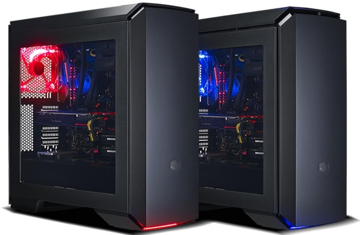
Eccellenti anche le capacità di raffreddamento con la possibilità di installare tre ventole da 120 o 140mm sul frontale, una da 120 o 140mm sul retro e due da 120 o 140mm sul top.
