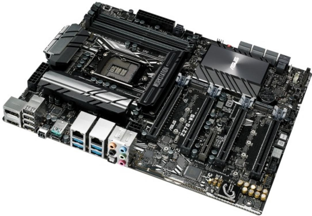
La dotazione della Z270-WS prevede una sezione audio di tutto rispetto basata su chipset Realtek S1220A con supporto alle tecnologie Crystal Sound 3 ed X Technology così da garantire un audio impeccabile.
