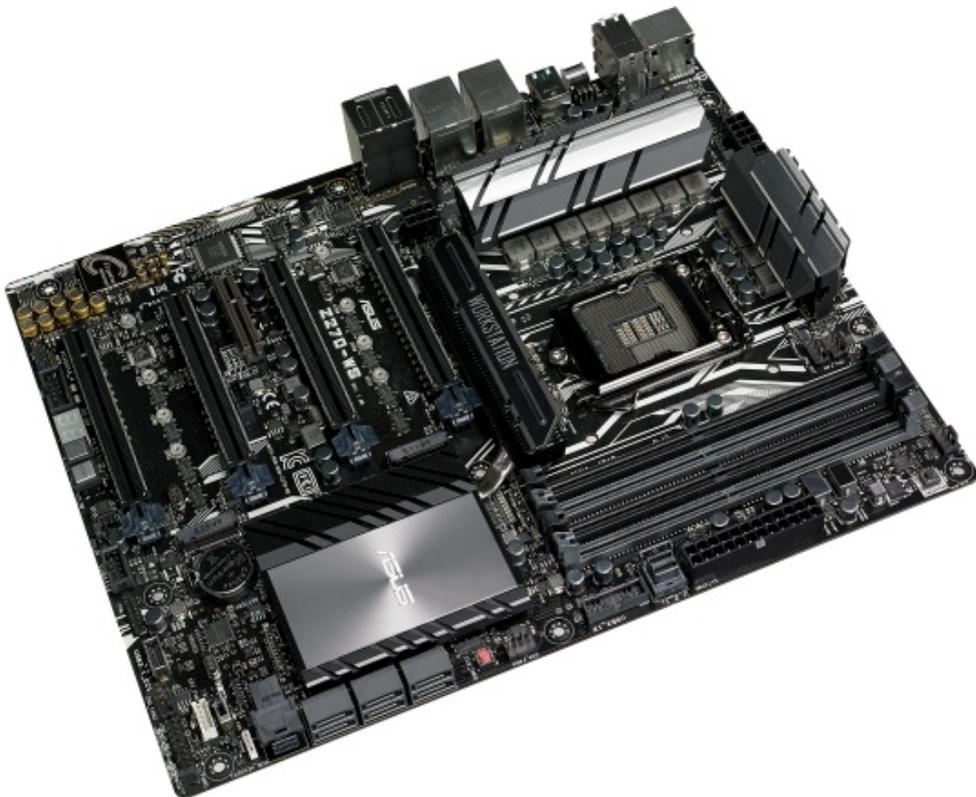
La nuova Z270-WS dispone di quattro slot PCI Express x16, dotati di tecnologia SafeSlot, che permettono di supportare altrettante schede grafiche dual slot in configurazione SLI o CrossFire.
