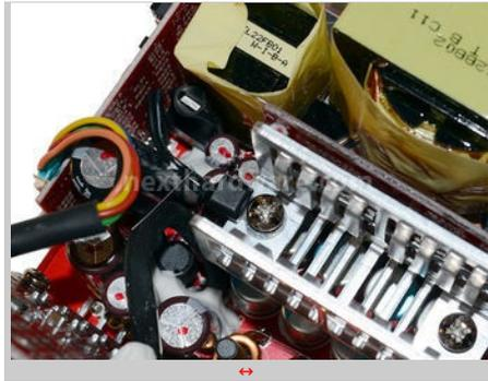
Particolare della sonda di temperatura ancorata al dissipatore dello stadio secondario.
