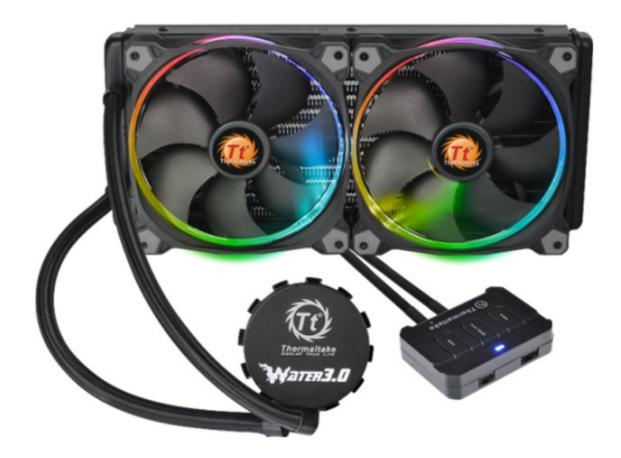
Il Thermaltake Water 3.0 Riing RGB 280 va a completare la categoria di AiO dotati di ventole Riing RGB aggiungendo, alla gamma composta da radiatori da 240 e 360mm, una versione dotata di radiatore da 280mm coadiuvata, per l'appunto, da due Riing 140 RGB provviste di controller interno per la selezione del colore, degli effetti e della velocità di rotazione.
