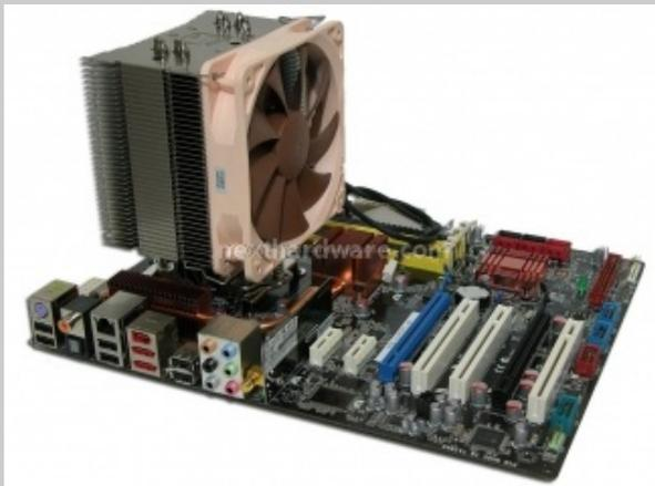
Apprezziandolo quindi anche montato sulla scheda madre. Vi rammentiamo che solo al primo montaggio sarà necessario operare con la scheda al di fuori del cabinet. Il sistema di ritenzione ci permetterà, per le operazioni di manutenzione future, di effettuare lo smontaggio del cooler senza dover rimuovere la motherboard.
