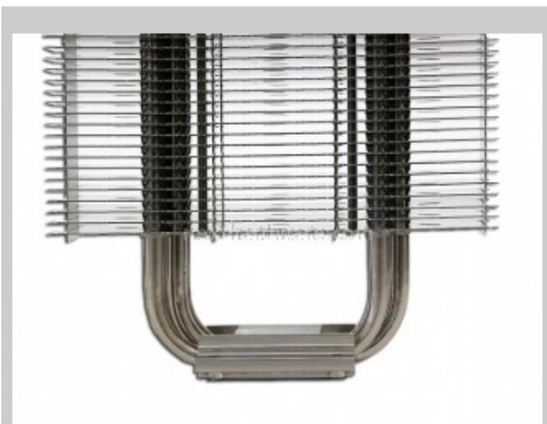
Vista frontale ed un'immagine ravvicinata che mostra quanto spazio è stato lasciato tra la base e la prima aletta. Questo per garantire compatibilità assoluta e per scongiurare problemi di contatto con componentistica e dissipatori della zona socket. Concorrono a conferire rigidità alla struttura anche due assi, ben visibili nella foto di destra appena all'interno delle heat pipes.
