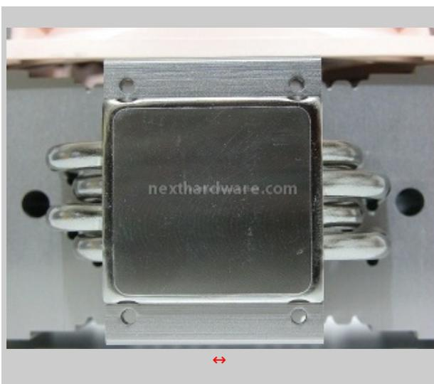
La base del dissipatore si presenta curata e sicuramente planare, sono comunque visibili i "segna" della rettifica, anche se in misura minima. Verificheremo anche il contatto per assicurarci ulteriormente della planarità .
