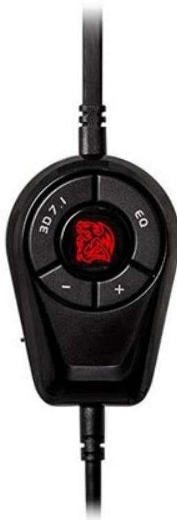
La soluzione DAC integrata è interfacciabile al PC via USB, essenziale per l'alimentazione dei LED come anche per la regolazione dell'equalizzatore software ed altri controlli, completati dalla presenza di un dongle in linea per impostazioni veloci senza interrompere il gioco.
