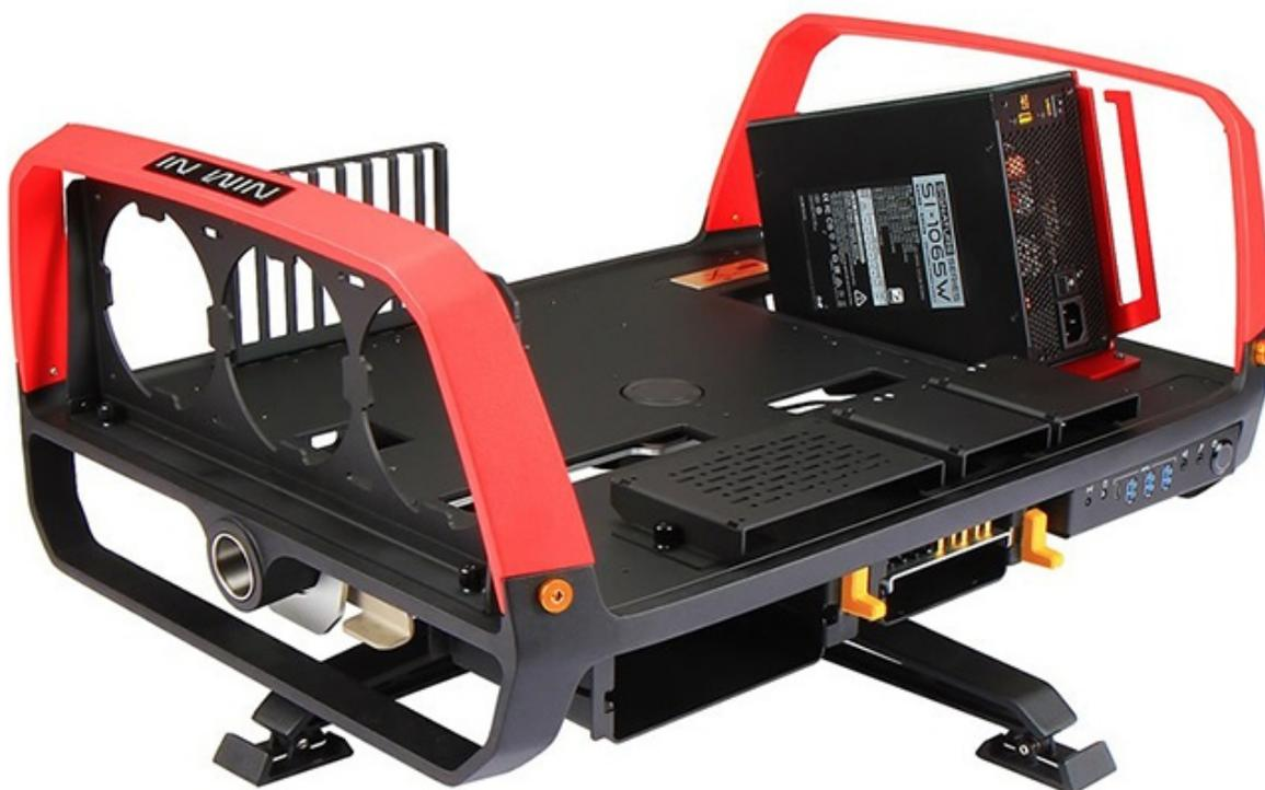
Il design open frame vede la presenza di un piatto mainboard da 640x483x330mm (AxLxP) in grado di contenere, oltre a mainboard sino al formato ATX, anche l'alimentatore (nella parte alta), schede video di imponenti dimensioni, impianti a liquido complessi con radiatore da 360mm, pompe di qualsiasi tipo e due drive da 2,5" con sistema di sgancio rapido.
