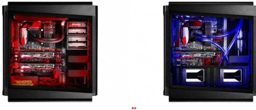
Ottima anche la predisposizione per i sistemi di raffreddamento sia ad aria che a liquido, con la possibilità di installare due ventole da 140mm o tre da 120mm sul frontale (due già presenti), una da 120mm o 140mm sul retro (di cui una da 120mm inclusa) e due da 140mm o tre da 120mm sul top.
