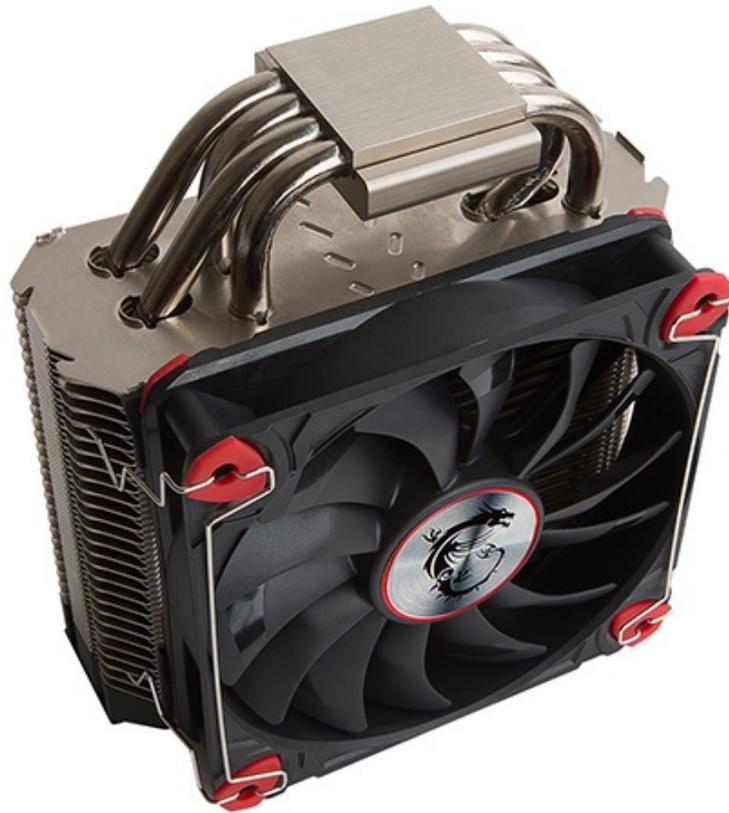
Il dissipatore è connesso alla base attraverso quattro heatpipes in rame dal diametro di 8mm e, grazie alla base decentrata, è in grado di abbinarsi perfettamente a qualsiasi mainboard senza causare problemi di compatibilità con moduli RAM ad alto profilo o dissipatori per le fasi particolarmente ingombranti.
