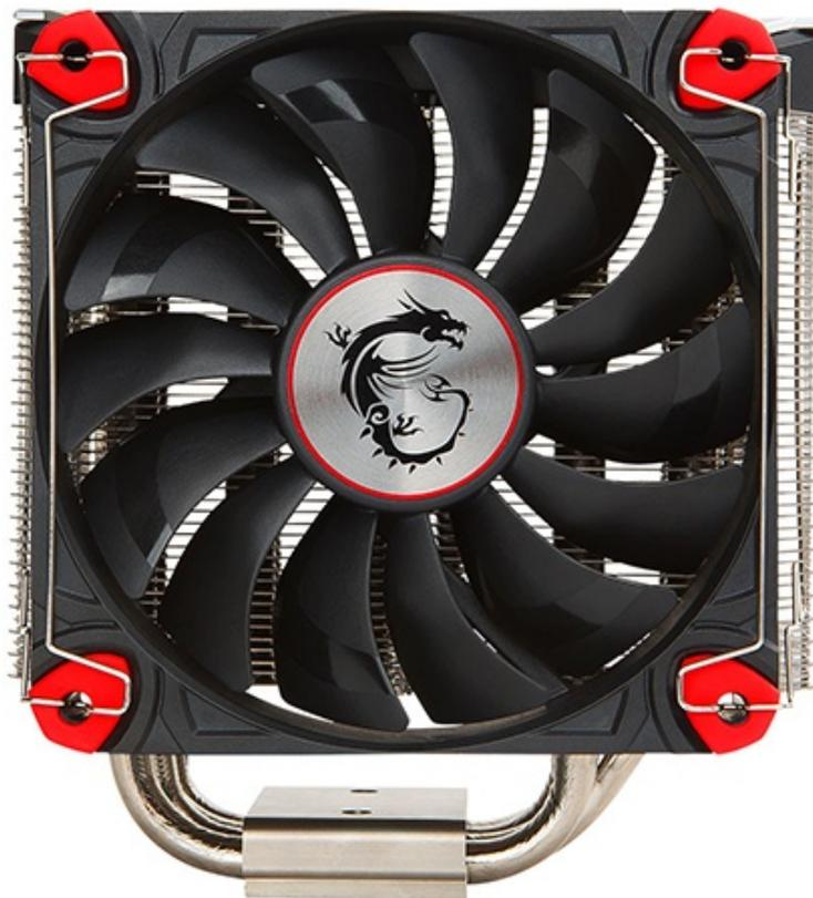
Quest'ultima è infatti dotata di connessione 4 pin PWM ed in grado di variare il proprio regime di rotazione da 500 a 1800 RPM, generando un flusso di aria massimo di 71.27 CFM con una pressione statica di 2.09
