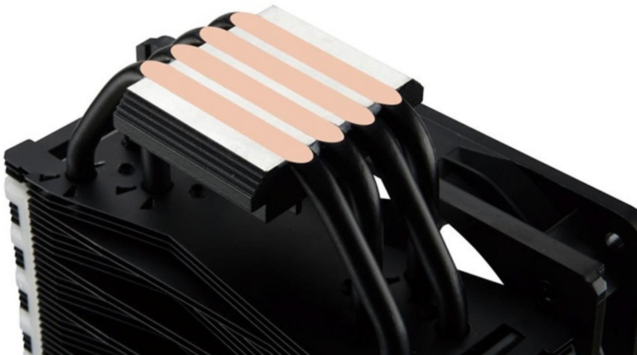
L'intera zona dissipante è collegata alla base tramite quattro heatpipes da 6mm in rame a diretto contatto con la CPU.
