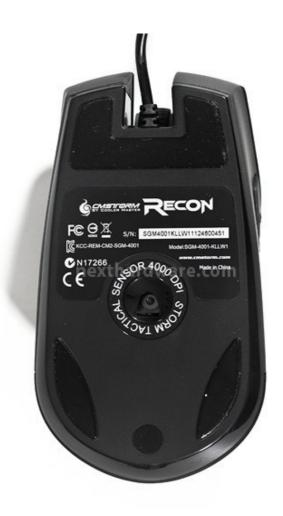
Nella parte inferiore possiamo notare il posizionamento leggermente arretrato del sensore ottico Avago 3090 e dei padsurfer in PTFE ad elevato scorrimento adottati.
