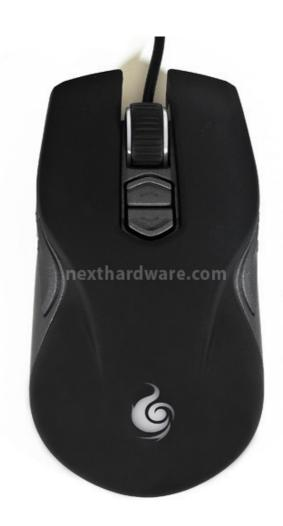
E' evidente, in questa prima vista dall'alto, l'assoluta simmetria delle forme che rende il CM Storm Recon utilizzabile anche dai mancini, caratteristica piuttosto rara per un mouse di buon livello.
