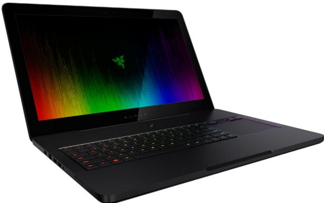
Con una potenza mai vista prima in un laptop spesso meno di 22,5mm, il nuovo gioiello Razer è in grado di gestire praticamente ogni attività , ovunque e in ogni momento, grazie al processore quad core Intel Core i7 ed alla scheda video NVIDIA GeForce GTX 1080 (Mobile).↔
