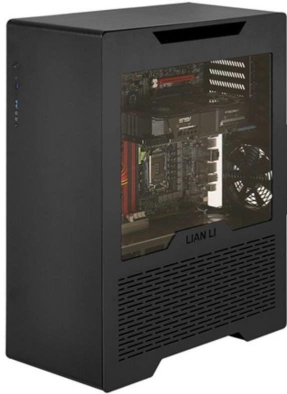
Il PC-V3000, che dovrebbe vedere la luce entro la fine dell'anno, prevede un design a doppio scomparto con il layout della scheda madre invertito (Reverse ATX), ovvero con l'apertura che ne permette l'accesso situata sul lato destro.
