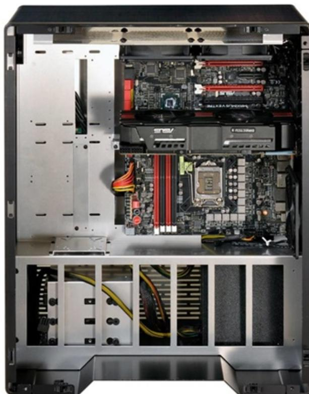
Il vano inferiore è ulteriormente suddiviso in verticale, in maniera tale da avere sul lato sinistro lo spazio destinato all'alimentatore e ad un cestello removibile per drive da 3,5", mentre sul lato destro sarà possibile installare radiatori anche da 420mm ed un cospicuo numero di SSD.
