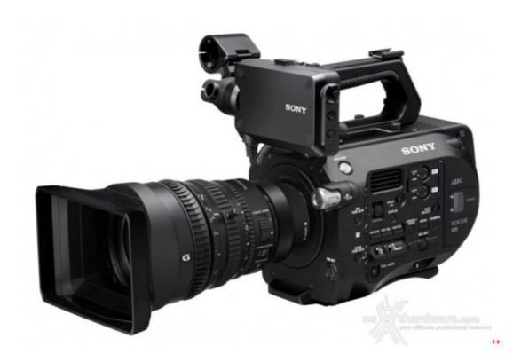
**Sony** ha annunciato la **PXW-FS7**, la prima fotocamera **4K XDCAM** caratterizzata da un sensore CMOS Super35, in grado di produrre riprese in **4K Quad Full HD** e **Full HD** super slow-motion.
