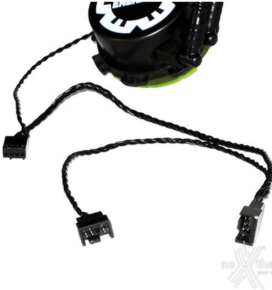
La regolazione di quest'ultime, essendo di tipo PWM, verrà affidata alla scheda madre che gestirà, in base al carico ed alle temperature rilevate, il range di velocità impostato tramite gli switch posti sulle stesse.
