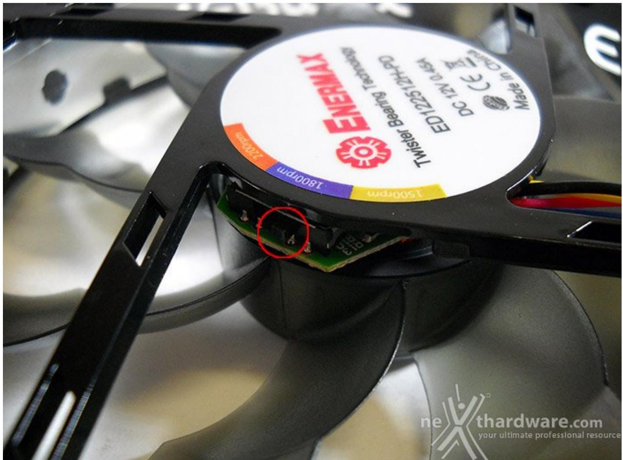
La vera particolarità delle ventole in bundle è sicuramente l'introduzione dello switch a tre vie per la selezione delle tre modalità di raffreddamento (Silent, Performance e Overclock).
