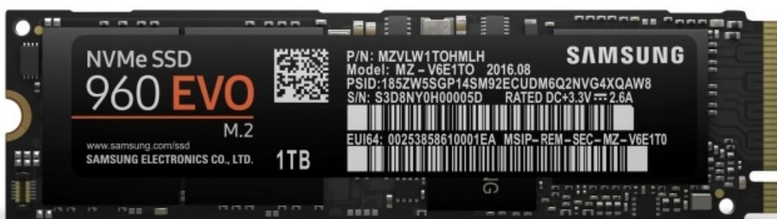
Stesso discorso per i 960 EVO, a loro volta mutuati dai PM961, dotati del medesimo controller Polaris, ma di 3D V-NAND di tipo TLC coadiuvate da una tecnologia di caching SLC ulteriormente migliorata, denominata ora "Intelligent TurboWrite".
