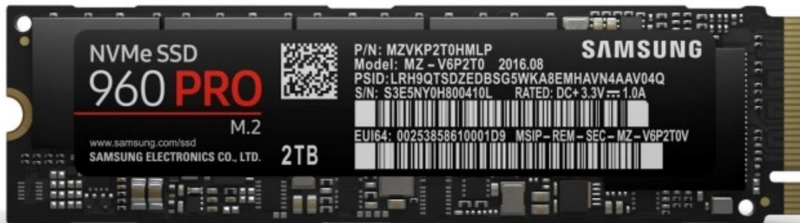
Derivati direttamente dagli SM961, una versione OEM la cui disponibilità è sempre stata piuttosto limitata, i 960 PRO ne ereditano il nuovo controller Polaris e le velocissime 3D V-NAND 48-layer di tipo MLC e costituiscono la soluzione di punta per l'offerta consumer con capacità comprese tra i 512GB ed i 2TB.
