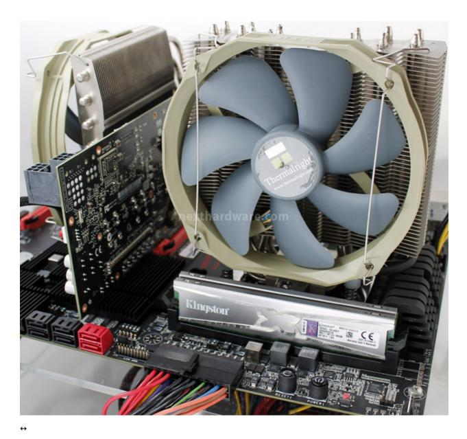
In questa serie di test ci siamo limitati ad un leggero overclock del sistema, determinando la massima↔ frequenza stabile per la CPU compatibilmente con il raffreddamento utilizzato, il divisore di memoria più appropriato ed impostando una tensione d'esercizio massima per **VDRAM** e **VCCSA**, rispettivamente, di **1,70Volt** e **1,30Volt**.
