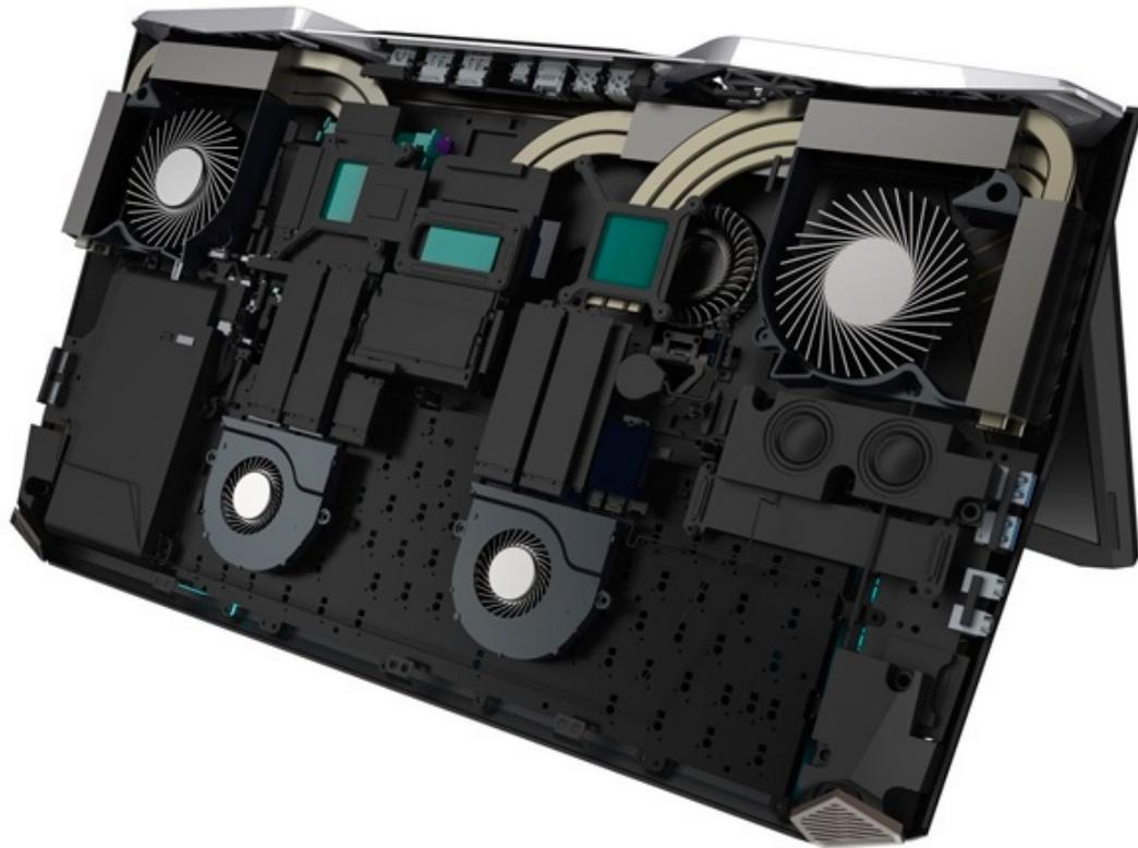
Ovviamente le dimensioni e gli 8kg di peso hanno favorito la progettazione di un sistema di raffreddamento all'altezza che consta di ben cinque ventole, tre delle quali sono AeroBlade costruite interamente in metallo.
