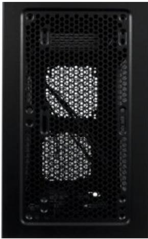
La parte alta del case in grado di ospitare due ventole da 120mm.
