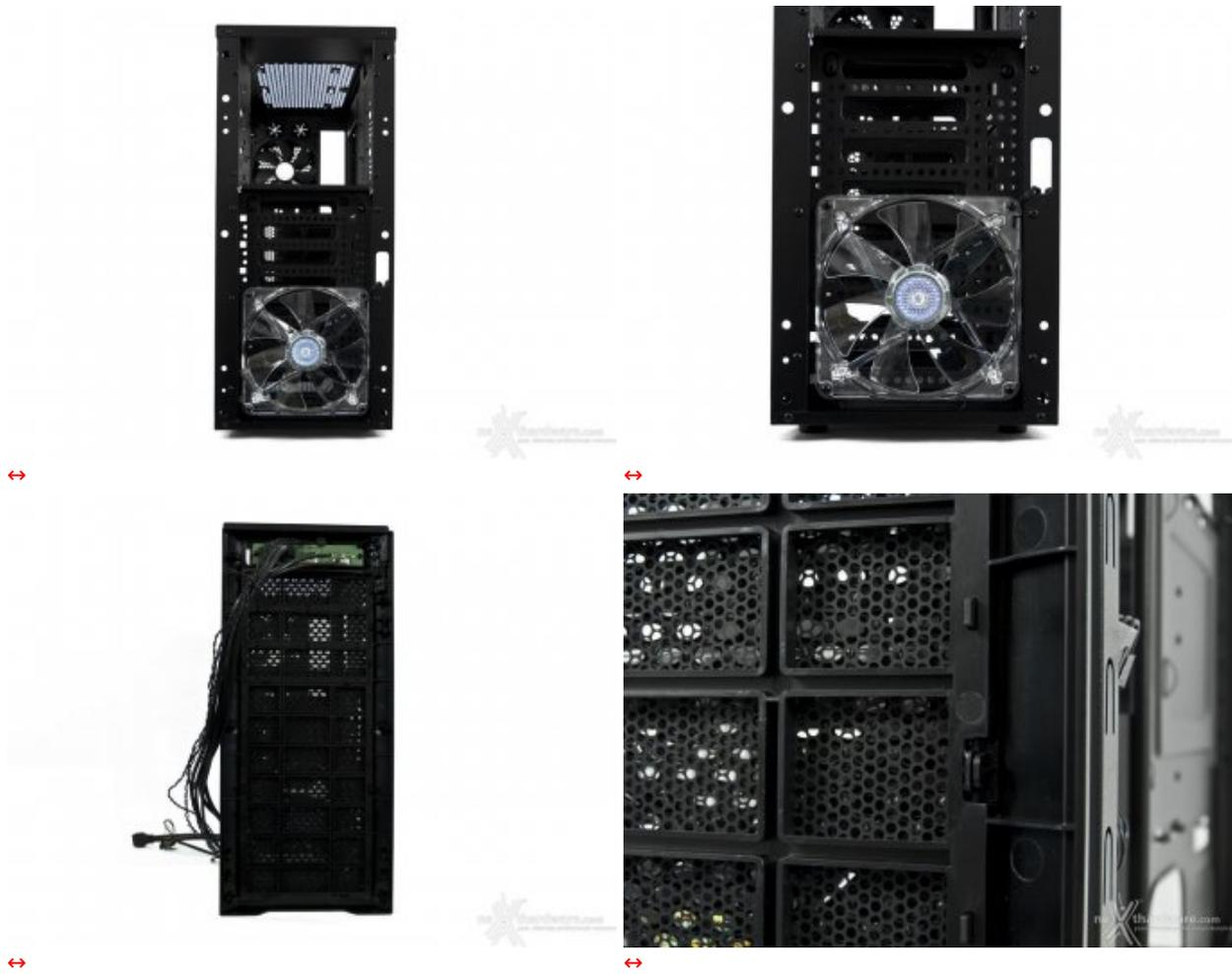
Il pannello frontale è facilmente removibile: basta premere sei inserti in plastica per separarlo dalla struttura del case.
