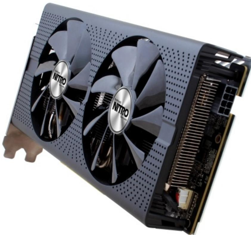
La scheda dispone di PCB completamente ridisegnato, un connettore di alimentazione a 8 pin, condensatori allo stato solido, nuovi induttori Black Diamond Mark 4 ed un doppio BIOS che permette di variare i parametri di assorbimento energetico ed il power target della GPU per ottenere la massima stabilità in overclock.
