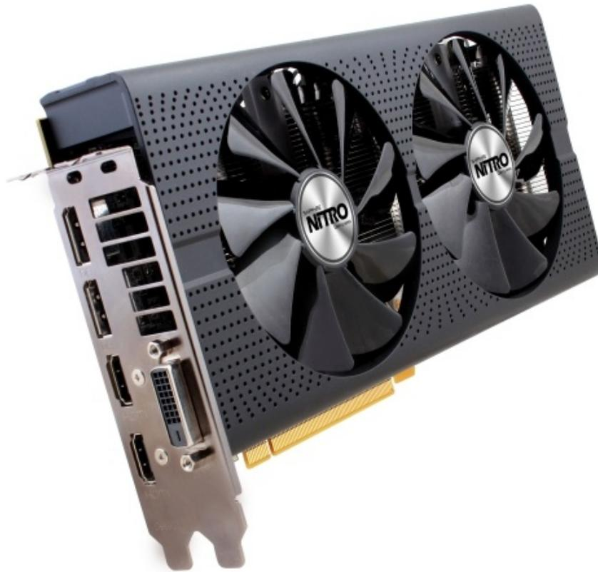
La terza generazione del sistema Intelligent Fan Control, inoltre, disattiva completamente le ventole in condizioni di carico leggero e, con l'ausilio di NITRO CoolTech, le riavvia esattamente a 52 °C per ottenere in modo trasparente il giusto equilibrio tra prestazioni e rumorosità .
