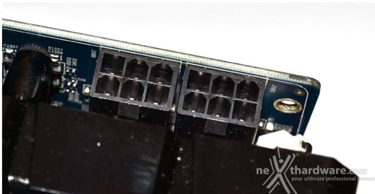
Per garantire la corretta alimentazione della scheda è necessario collegare due cavi PCI-E 6pin utilizzando, all'occorrenza, gli adattatori Molex/PCI-E inclusi nella confezione.
