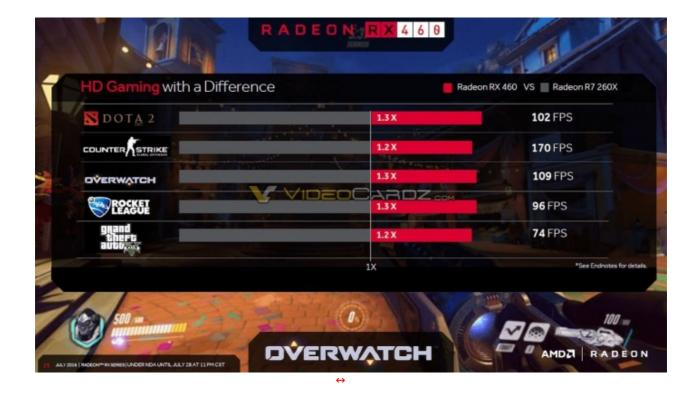
Ancora più parca la nuova "entry-level" RX 460, basata su di un chip Polaris 11 "Baffin" da 896 Stream Processor con bus a 128bit e 2/4GB memoria GDDR5 a 7Gbps, le cui richieste energetiche non dovrebbero superare quota 75W, ovvero il massimo erogabile con il solo slot PCIe.
