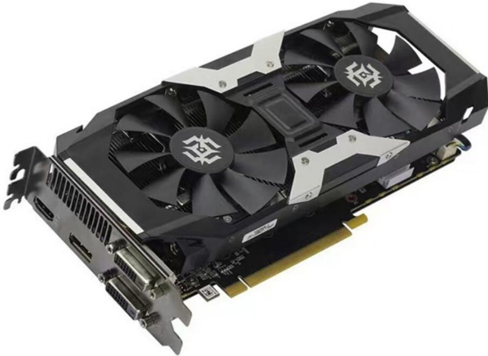
La X-Gaming, che non pare puntare all'originalità, offre un PCB custom con sezione di alimentazione a 4+1 fasi, connettore da 8 pin ed un aggressivo dissipatore dual fan: non è certa, comunque, la sua disponibilità sul vecchio continente.
