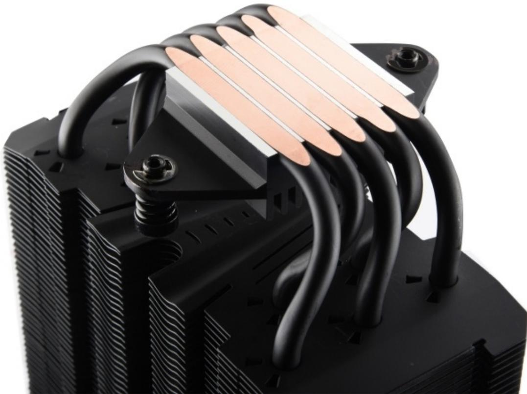
Il corpo dissipante è connesso alla base attraverso 5 heatpipes in rame dal diametro di 6mm che, per garantire un migliore scambio termico si affidano alla tecnologia HDT (Heat-Pipe Direct Touch), risultando a diretto contatto con la CPU.
