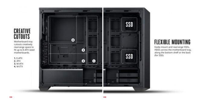
Al suo interno, nonostante sia un Mid Tower, possono essere ospitate schede madri sino al formato E-ATX, tre schede video a doppio slot con una lunghezza massima di 410mm e impianti a liquido professionali o All-in-One con radiatori da 360mm.
