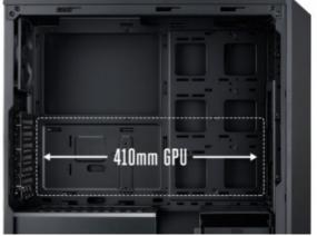
Le staffe removibili per SSD e gli alloggiamenti per HDD possono essere riorganizzati in tutto il case: si può scegliere di mostrare o nascondere il proprio comparto di storage grazie a nove posizioni di montaggio, di cui quattro nella parte posteriore o, in alternativa, è possibile rimuovere tutti gli alloggiamenti dal vassoio della scheda madre per un look più pulito privilegiando il sistema di raffreddamento.
