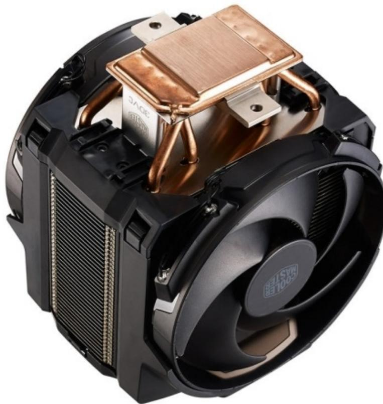
Il Cooler Master Master Air Maker 8 adotta un totale di otto heatpipes, di cui quattro direttamente saldate alla base, che si occupano di spostare tutto il calore dalla stessa verso il corpo dissipante realizzato con un gran numero di alette di alluminio.
