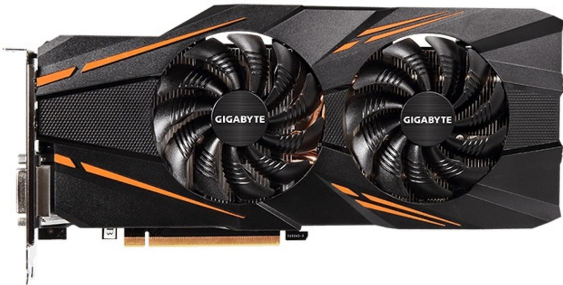
La GTX 1070 WindForce OC, alimentata da un singolo connettore PCI-E 8 pin, offre due modalità di funzionamento, entrambe con un leggero overclock di fabbrica, la "OC Mode" con frequenza della GPU pari 1582MHz/1771MHz e la "Gaming Mode" con GPU operante a 1556MHz/1746MHz.
