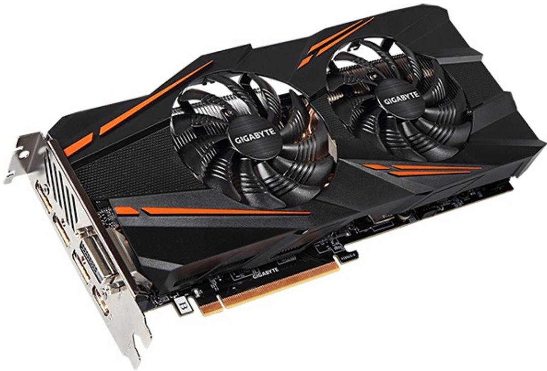
Il WindForce 2X prevede un corpo dissipante realizzato con un gran numero di alette di alluminio e ventilato da una coppia di ventole da 90mm, che rimangono spente quando la VGA si trova in stato di idle.
