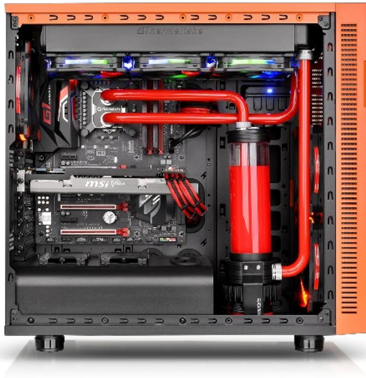
Il Pacific RL360 D5 e il Pacific RL240 D5, rispettivamente basati su radiatori da 360mm e 240mm con ventole Riing RGB da 120mm, giungono completi di un waterblock Pacific W1, una combo tanica/pompa Pacific PR22-D5, sei raccordi cromati Pacific G1/4 e quattro tubi rigidi da mezzo metro ciascuno, oltre ad accessori vari ed una bottiglia di liquido C1000 rosso opaco.
