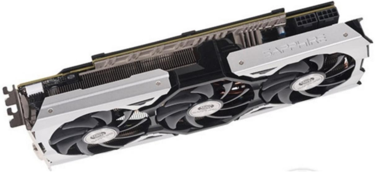
Tale combinazione risulta micidiale per quanto concerne l'abbattimento delle temperature, che risultano addirittura inferiori di 5/10 °C rispetto all'utilizzo del solo, ma comunque efficientissimo, dissipatore Tri-X.
