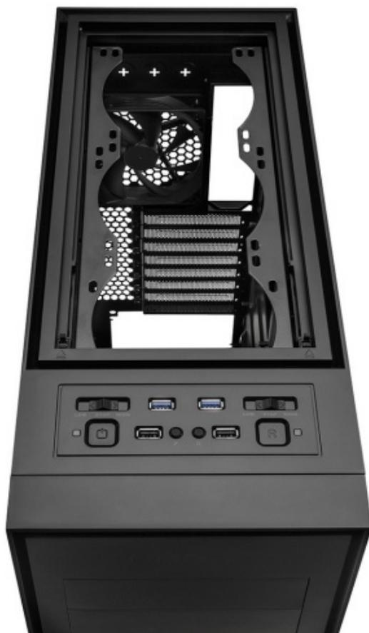
Prevista anche la possibilità di installare un sistema a liquido professionale per il quale sono previste due predisposizioni per radiatori, una anteriore da 240mm ed una superiore da 240, 280 o 360mm, oltre a degli specifici supporti (forniti in dotazione) per le pompe dedicate.
