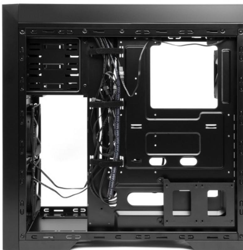
Per quanto concerne il comparto di storage, il P9 è in grado di ospitare tre drive da 5,25", otto da 3,5" (con predisposizione anche da 2,5") e due da 2,5", tutti installabili in modalità tool-less.
