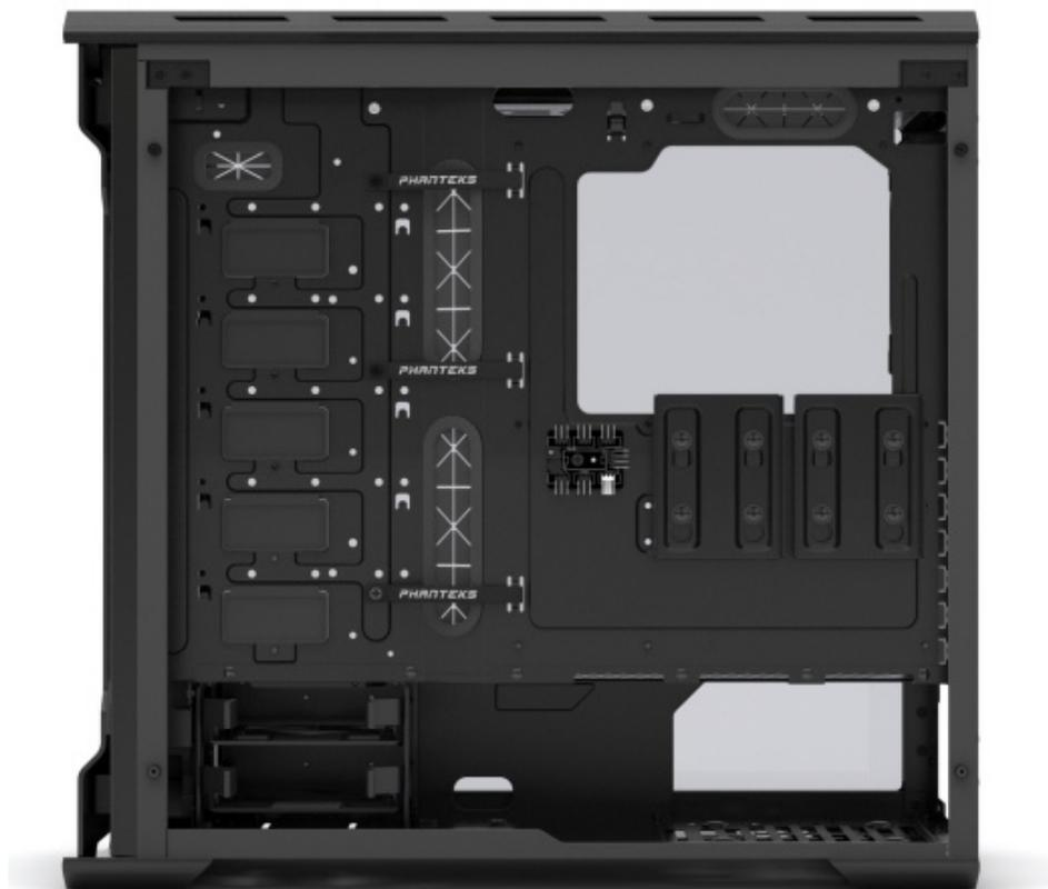
L'Enthoo EVOLV ATX Tempered Glass Edition è dotato di tre ventole Phanteks PH-F140SP, due staffe da 2.5" per l'installazione di SSD, tre da 3,5" per tradizionali dischi meccanici, un sistema a scomparsa per il fissaggio di un radiatore e filtri removibili a protezione delle ventole.
