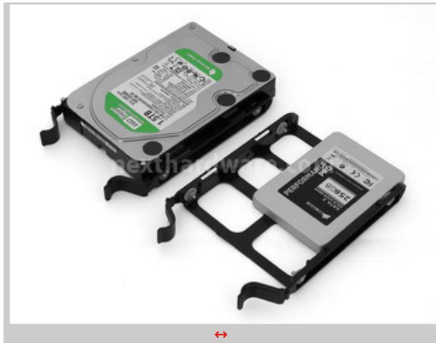
Le slitte per HDD equipaggiate con i drive da installare.
