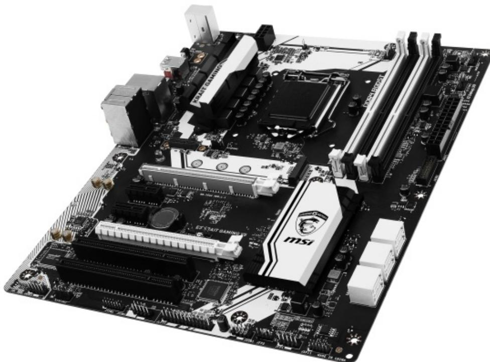
Molto valido anche il comparto di storage che, grazie agli slot Turbo M.2, di cui uno pronto per tutti i moderni SSD e l'altro per moduli opzionali Wi-Fi/Bluetooth e qualsiasi altro dispositivo compatibile, è in grado di supportare unità sia in modalità SATA che PCI-E di varie lunghezze (4.8/6/8/11cm).
