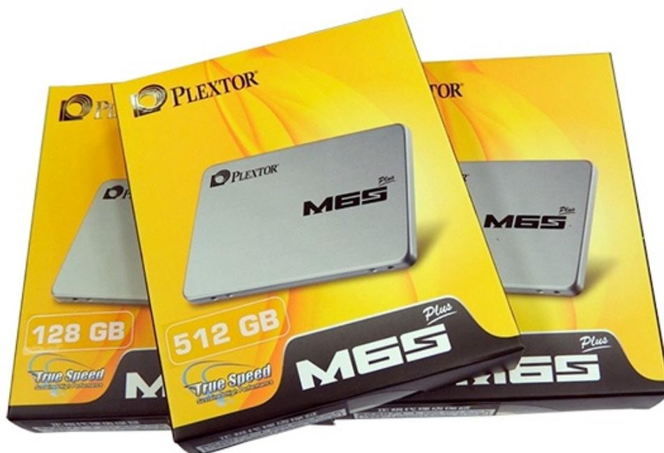
Tutti e tre gli SSD offrono prestazioni in lettura sequenziale pari a 520 MB/s, mentre la velocità di scrittura sequenziale varia da 300 MB/s fino 440 MB/s a seconda della capacità .
