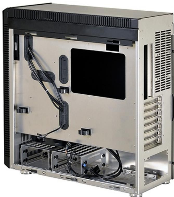
Nel vano inferiore abbiamo due cestelli estraibili per HDD/SSD dotati di gommini antivibrazione, in grado di ospitare ciascuno due unità .
