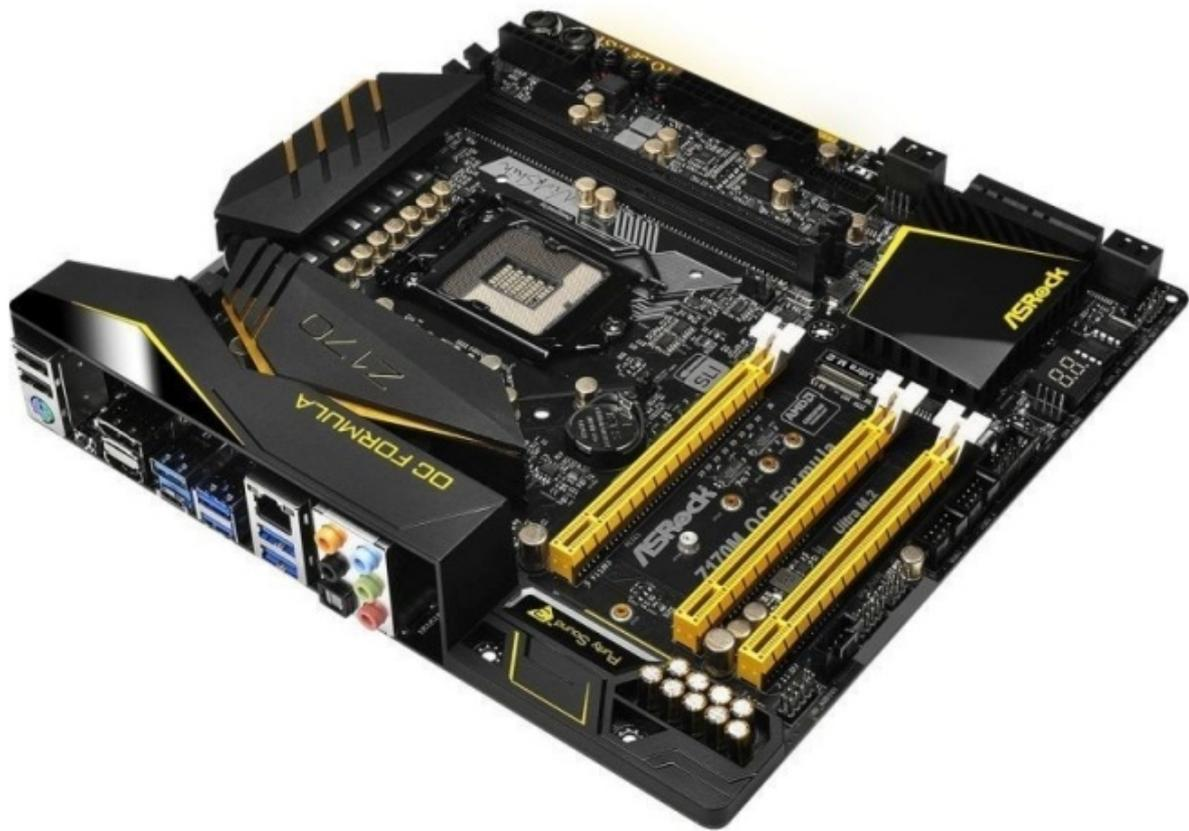
La nuova mainboard offre tutta una serie di caratteristiche per l'overclock come i punti di misura delle tensioni, il pulsante per l'overclock automatico, i LED diagnostici e due chip EEPROM ridondanti per il BIOS.
