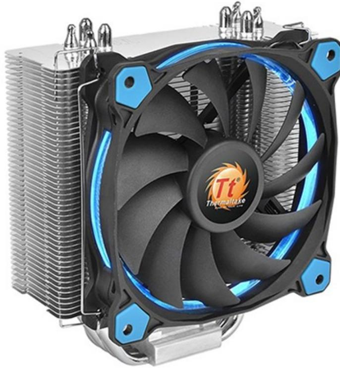
La particolarità di tale soluzione, come lascia intuire il nome, risiede nella presenza di una ventola Riing PWM da 120mm, composta da 11 pale in grado di spostare un'ingente quantità di aria, cuscinetti idraulici per l'abbattimento del rumore e, soprattutto, il "LED Riing", ovvero una banda luminosa facente parte del supporto.
