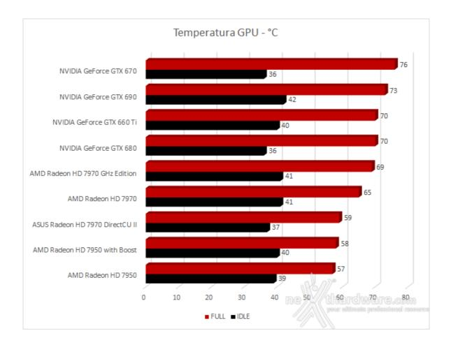
L'efficienza del dissipatore DirectCU II è notevole, consentendo alla HD 7970 di ASUS di operare a temperature vicine a quelle della meno potente AMD Radeon HD 7950 with Boost.
