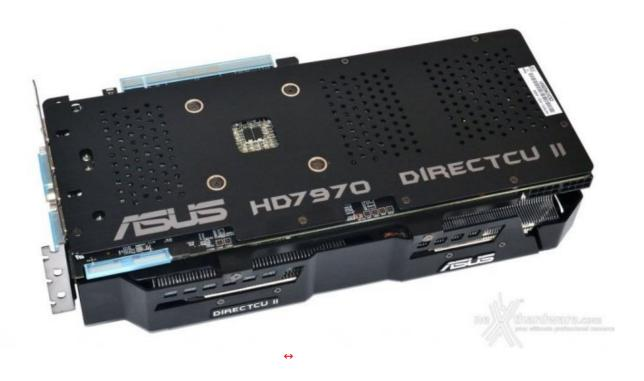
Il retro del PCB è coperto da una placca in alluminio che garantisce sia una migliore dissipazione del calore prodotto dalla scheda, sia un'ulteriore protezione contro i danneggiamenti accidentali.
