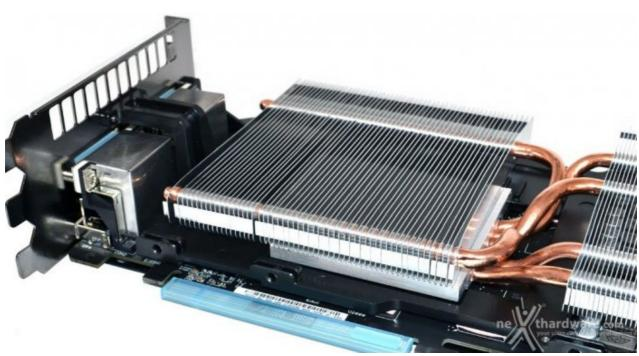
Una volta rimossa la copertura, è possibile ammirare il sistema di raffreddamento DirectCU II composto da due radiatori in alluminio e ben sei heatpipes che vanno a posizionarsi sopra la GPU.
