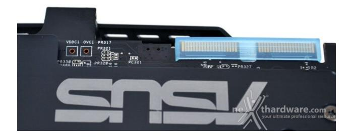
Questa tecnologia è dedicata esclusivamente agli overclockers più esperti che, mettendo mano al saldatore, potranno monitorare e modificare le tensioni di alimentazione della scheda video direttamente dal BIOS della scheda madre, senza la necessità di dover utilizzare trimmer multigiri e strumenti di misura esterni.
