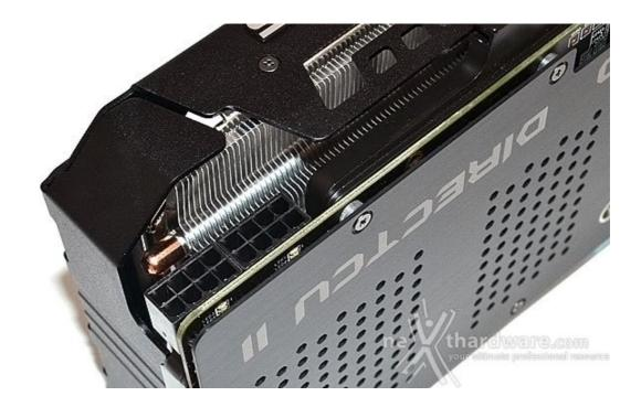
A differenza del modello di riferimento AMD, la HD 7970 DirectCU II di ASUS richiede 2 connessioni di alimentazione PCI-E 8 pin, disponendo così di un massimo di 375W in luogo dei canonici 300W forniti dalla coppia di connettori PCI-E 6 pin + PCI-E 8 pin.
