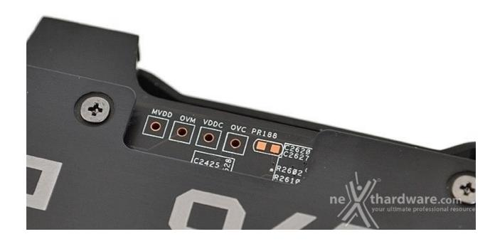
Per poter abilitare VGA HotWire è necessario cortocircuitare il ponticello PR188 e collegare i 6 cavi di controllo e regolazione agli appositi piedini situati sulla scheda madre.
