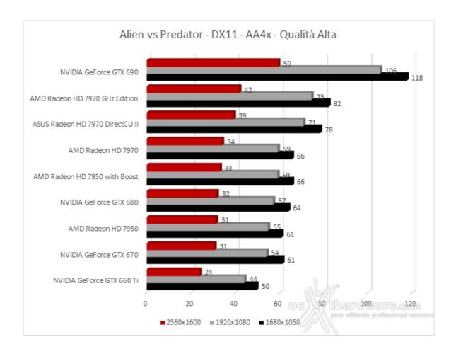
In Metro 2033 e Alien vs Predator la HD 7970 DirectCU II risulta più performante della GeForce GTX 680 basata sull'architettura NVIDIA "Kepler".
