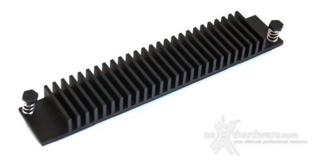
Nel caso si volesse utilizzare un sistema di raffreddamento differente, ASUS ha incluso un elemento in alluminio da utilizzare per raffreddare i mosfet della scheda video, una volta rimosso il dissipatore DirectCU II.
