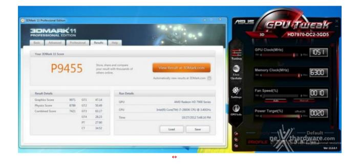
Durante le nostre prove abbiamo portato la ASUS Radeon HD 7970 DirectCU II alla frequenza di 1051MHz per la GPU e 6300MHz per le memorie GDDR5; un risultato piuttosto interessante considerando le frequenze di base, rispettivamente, di 925 e 5500MHz, il tutto ottenuto senza intervenire sulla velocità di rotazione delle due ventole di raffreddamento.
