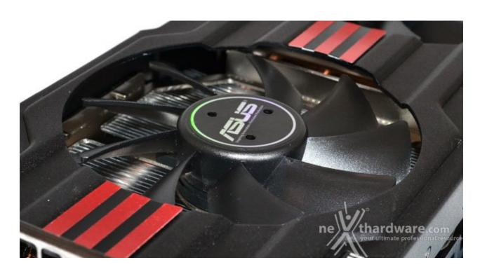
La temperatura a 5 centimetri dalla ventola della VGA è stata mantenuta costante a 30 gradi, condizione paragonabile a quella che si verifica all'interno di uno chassis tradizionale con una adeguata areazione.
