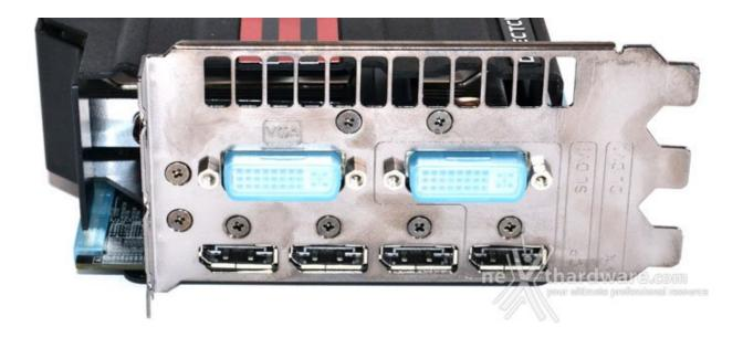
La HD 7970 DirectCU II dispone di 2 connessioni DVI Dual Link e di ben 4 connessioni DisplayPort che possono essere utilizzate contemporaneamente, anche se con alcune limitazioni.
