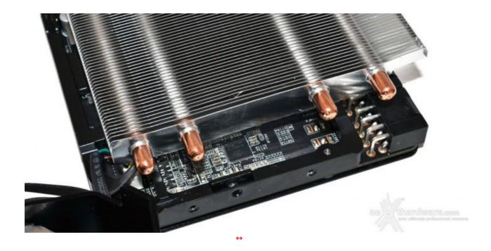
Il design del sistema di raffreddamento della HD 7970 DirectCU Il consente di espellere la maggior parte dell'aria calda all'esterno dello chassis, sfruttando la griglia di ventilazione posta sulla staffa PCI.
