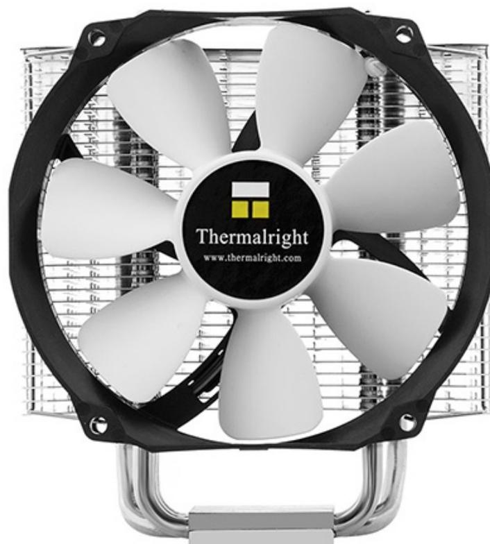
Quest'ultima appartiene alla serie TY ed è in grado di variare il regime di rotazione in base alla temperatura d'esercizio della CPU, passando dai 300 a 1300 RPM, con un aumento di portata da 21.9 a 94.8 m<sup>3</sup>/h.
