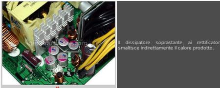
Il dissipatore soprastante ai rettificatori smaltisce indirettamente il calore prodotto.
