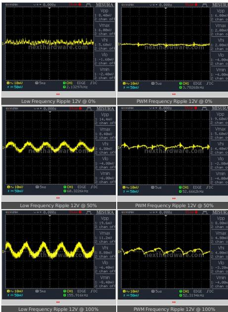
Il ripple sulla linea da 12V cresce all'aumentare del carico, passando da circa 8mV a poco meno di 20mV di oscillazione.
