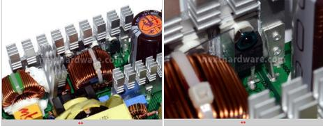
Il sistema di controllo del PFC, non perfettamente visibile, utilizza due MOSFET ed un diodo CR6E, prodotto da CRÉ, mediante i quali si agisce sull'induttore, in combinazione con il condensatore d'ingresso, per contenere lo sfasamento tra l'onda di tensione e di corrente.
