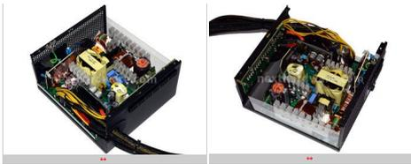
Nonostante le dimensioni già "ridotte" dello chassis, il PCB progettato da Seasonic occupa uno spazio ancora inferiore.
