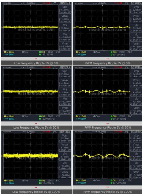
Sulla linea da 5V l'ampiezza dell'oscillazione è altrettanto contenuta con circa 12mV<sub>pp</sub> a pieno carico, abbondantemente sotto i 50mV ammissibili.
