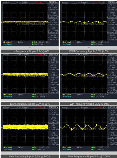
Leggermente superiore il ripple riscontrato sulla linea da 3.3V che, a pieno carico, presenta un'oscillazione di circa 14mV<sub>pp</sub>, ad ogni modo contenuta entro i limiti imposti dallo standard ATX.
