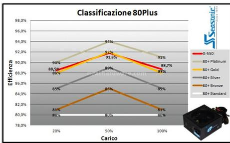
Questo grafico ci restituisce un quadro completo del posizionamento dell'alimentatore in test se confrontato con le varie certificazioni 80Plus correnti.
