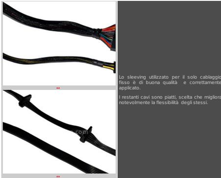
Lo sleeving utilizzato per il solo cablaggio fisso è di buona qualità e correttamente applicato.
