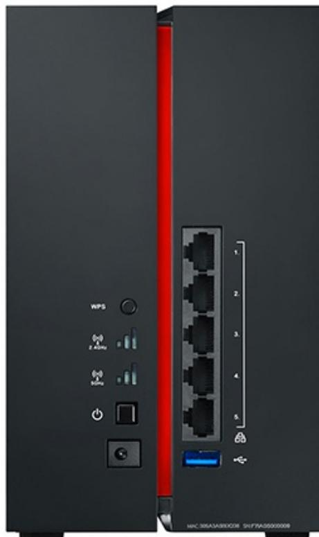
Le cinque porte Gigabit Ethernet di cui è dotato, poi, permettono di collegare altrettante periferiche dotate solo di tale connessione alla rete WiFi esistente.
