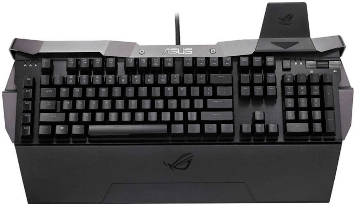
Lo chassis è in alluminio fresato a CNC, con gli switch direttamente installati sul plate principale in metallo per il massimo della rigidità ed un'elevata diffusione della retroilluminazione a LED rossi.
