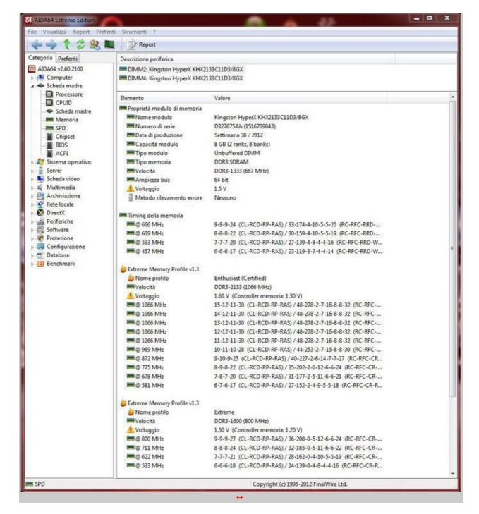
Nel Serial Presence Detect (SPD) è memorizzato il nome identificativo del kit, il produttore, il profilo standard JEDEC 1333MHz a 1,50V e la tipologia dei moduli.
