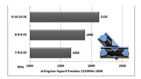
Dai test svolti si evince chiaramente come le nostre Kingston HyperX Predator possano operare tranquillamente con timings ridotti rispetto ai dati di fabbrica; utilizzando una impostazione pari a 10-11-12-9, infatti, abbiamo raggiunto i 2246MHz, un risultato sensibilmente superiore rispetto ai 2133MHz 11-12-11-30 del profilo XMP.
