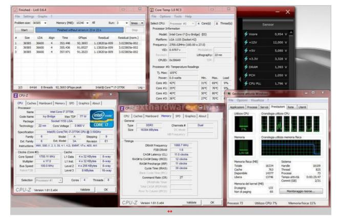
Ripetendo lo stesso test iniziale, abbiamo raggiunto la piena stabilità operativa con un tensione di alimentazione RAM di appena 1,40V, risultato che testimonia l'ottimo screening degli IC fatto da Kingston.
