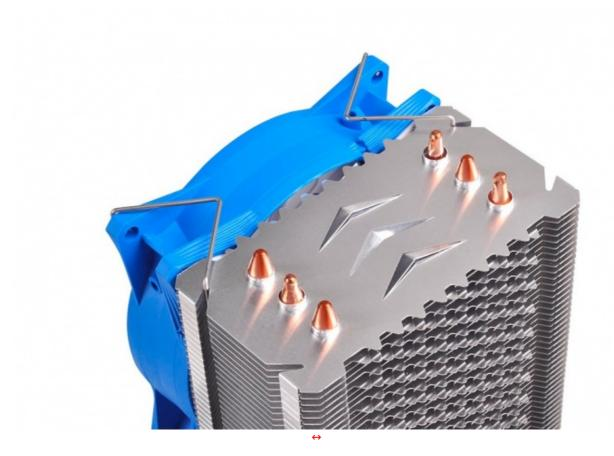
Entrambe le soluzioni sfruttano particolari accorgimenti atti a migliorare lo scambio termico come la tecnologia Heat-Pipe Direct Contact (HDC), che vede tre heatpipes (per lato) a diretto contatto con la CPU, e delle particolari feritoie sulle lamelle utili per facilitare il passaggio del flusso d'aria creato dalla ventola.
